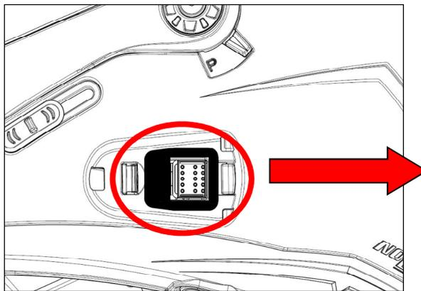
Sollten Probleme beim Einschalten des Systems oder Fehlfunktionen auftreten, vergewissern Sie sich bitte, dass **KEINE** Dichtung auf der elektronischen Grundplatte des Basic Kit2 angebracht ist.
